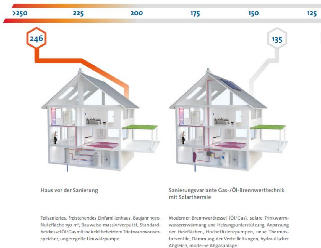
Abbildung 19 Einsparpotenziale durch Nutzung effizienter Heiztechnik (Quelle: BDH 2021)
