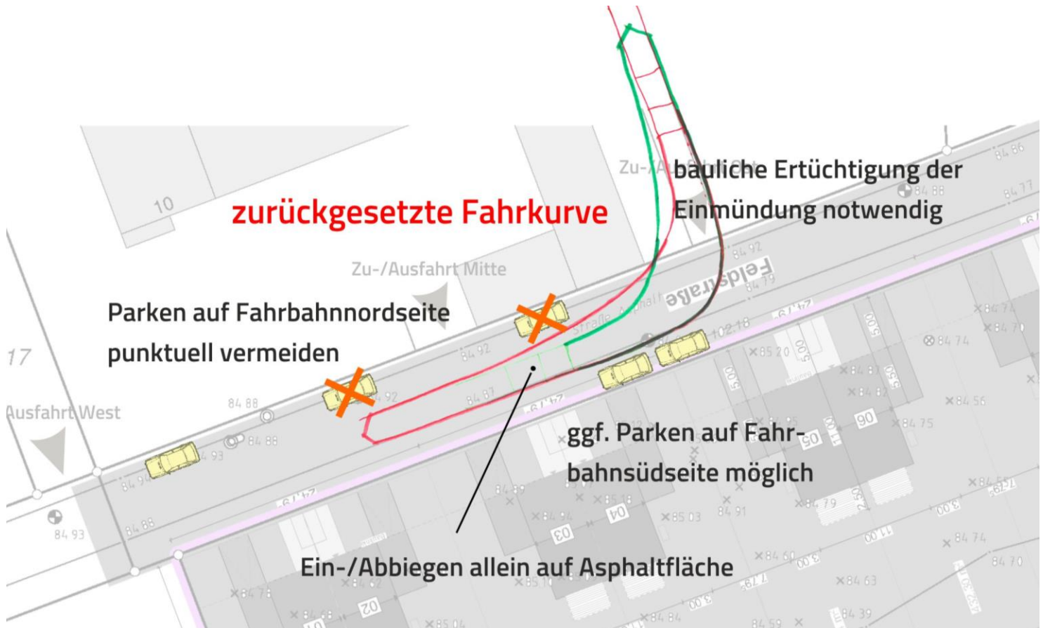
Abbildung 3.5: Schleppekurven – Ertüchtigung östliche Zufahrt (Maßstab 1:500)
